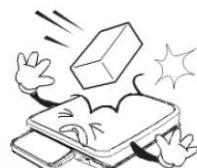
Váhu nevystavujte mechanickým rázům – mohlo by dojít k poškození tenzometrického snímače zatížení nebo elektroniky. Mějme na paměti, že váha je měřidlo a podle toho je třeba s ní zacházet.
