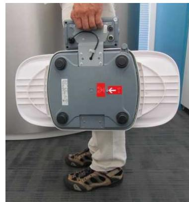
Pro snadnou manipulaci je možno váhu přenášet pomocí držáku
